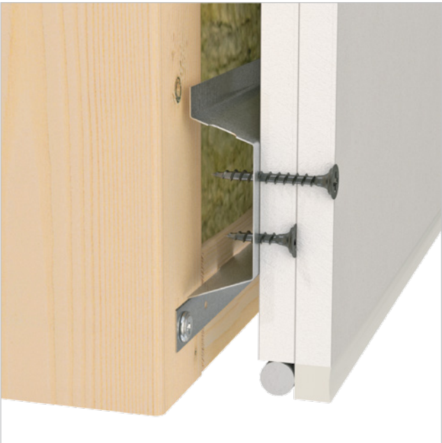
Akustikprofilen närmast golvet monteras så att den kan skruvas till syllen. Gipsskivorna monteras med ett avstånd på minst 10 mm till golvet*. Spalten tätas med elastisk fogmassa, sockellist bör limmas mot gipsskivorna. Om gipsskivorna ställs mot golvet försämras ljudisoleringen kraftigt.
