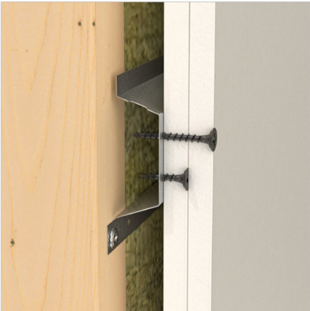
Första laget gipsskivor fästs med skruv för ett lag gips på stål och andra laget med skruv för två lag gips på stål. Skruven får inte vara så lång att den riskerar att nå stommen och orsaka en ljudbrygga.
