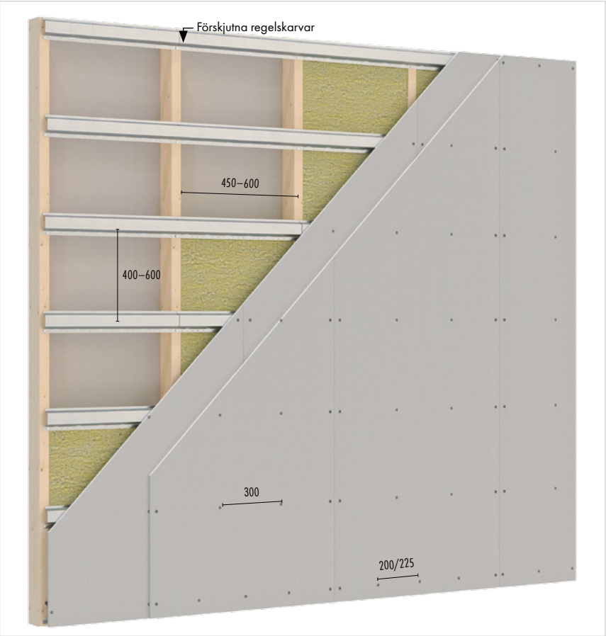
Akustikprofil AP monteras horisontellt på centrumavstånd enligt nedanstående tabell. Profilskarvarna bör förskjutas i förhållande till varandra.
