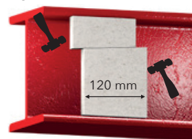
Montering av kil
